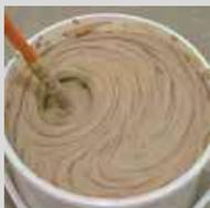
Gâcher le **weber.color junta ancha** avec 1,2 litres de l'eau propre par sac de 5 kg, manuellement ou bien avec un malaxeur électrique lent (500 rpm) jusqu'à obtenir une masse homogène et dépourvue de grumeaux. Laisser reposer deux minutes.
